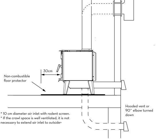
Figure 9. AB25 AUS INSTALL Diagram.
